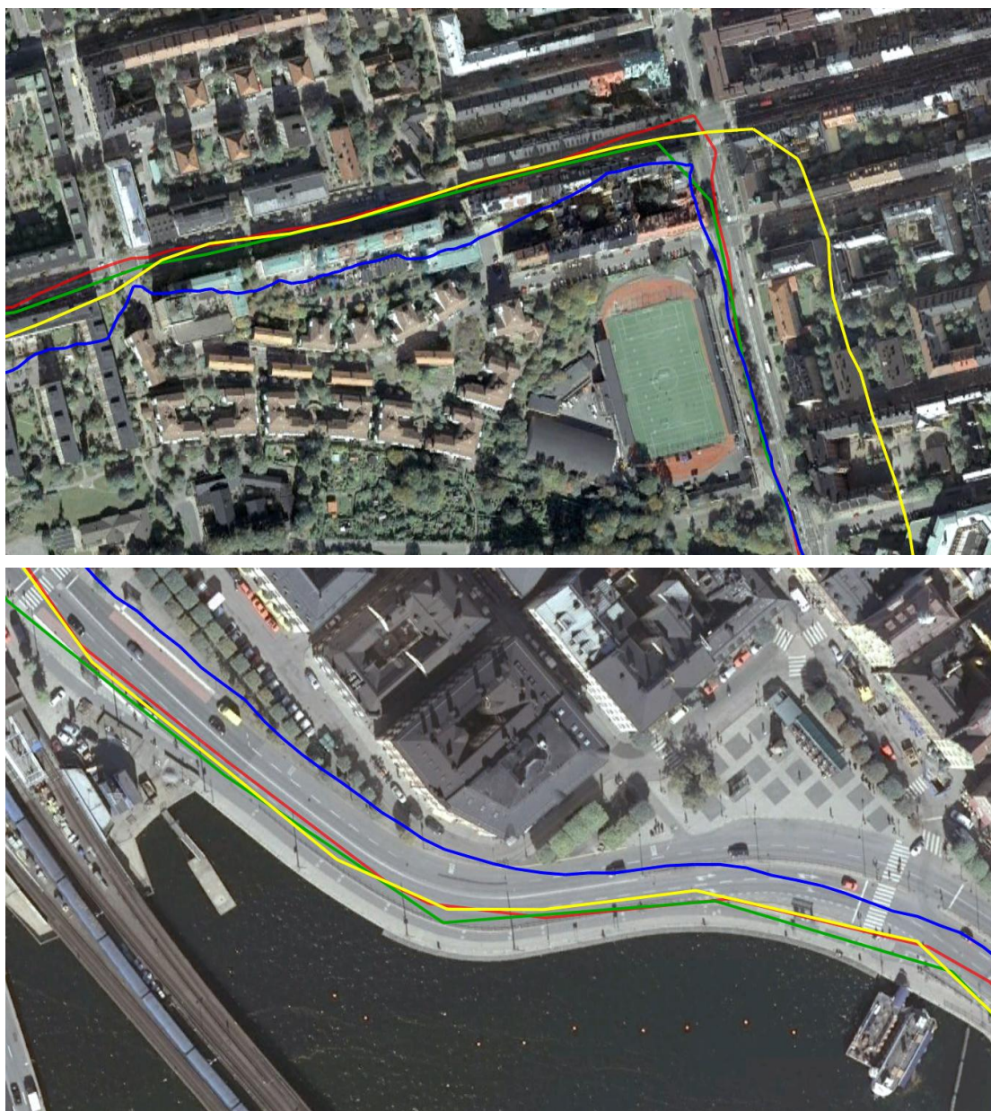
Figur 7. Skillnader mellan GPS:ernas loggningar. Garmin-klockan (Röd) och GlobalSat (Grön) är något bättre på att återge korrekt resväg jämfört Holux m241 (blå) och Garmin-dosan (gul) men också med Garmin-klockan (Röd) och GlobalSat (Grön) är det svårt att se exakt var på körbana eller cykelbana som cyklisten färdats.
