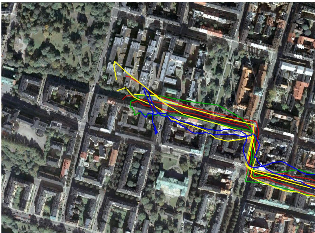
Figur 8. Starten av loggningarna av en rutt är inte alltid helt tillförlitliga.
