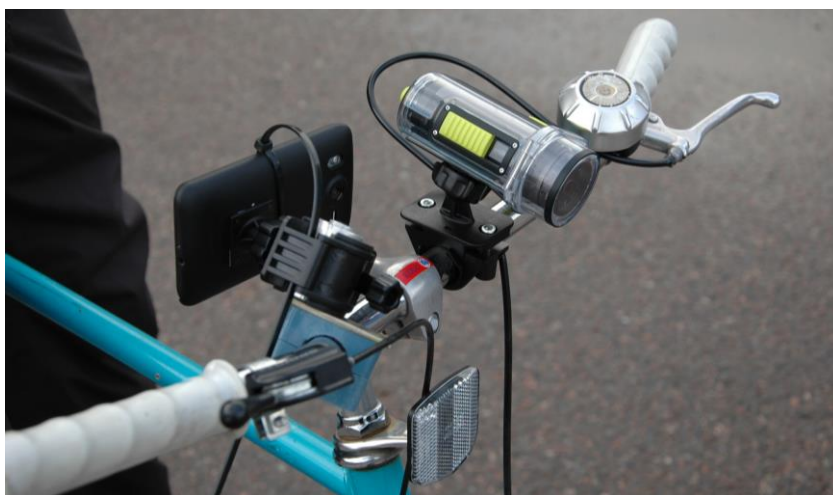
Figur 2 Smarttelefon monterad tillsammans med videosystemet vid inventering av Linköpings cykelvägar.
