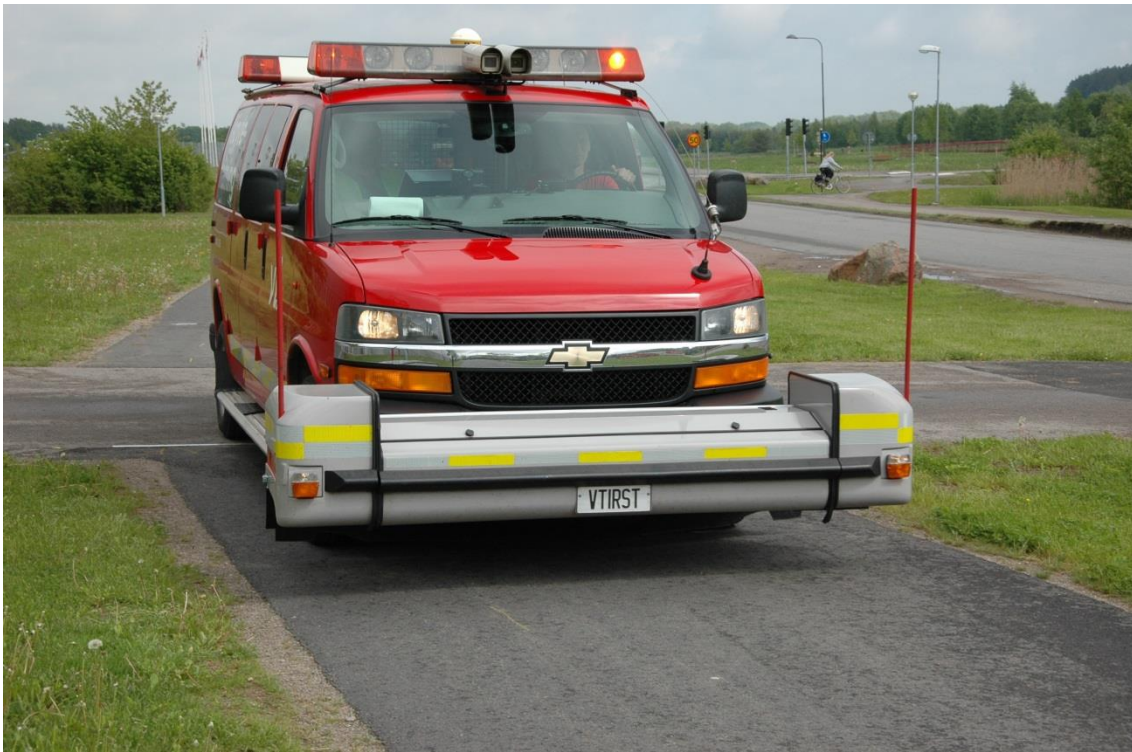
Figur 5 VTIs laser RST, under mätning av teststräcka E på campusområdet i Linköping.
